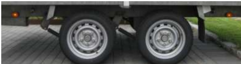
Sidemarkeringslygter med indbygget refleks
